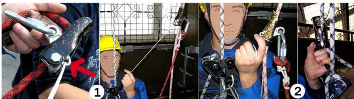
Рис.41. Иллюстрации опасного использования "Petzl Shunt" с сайта "Промальп" Новокузнецкого регионального центра промышленного альпинизма из статьи "Правила использования снаряжения от PETZL или русская смекалка в ущерб безопасности".
