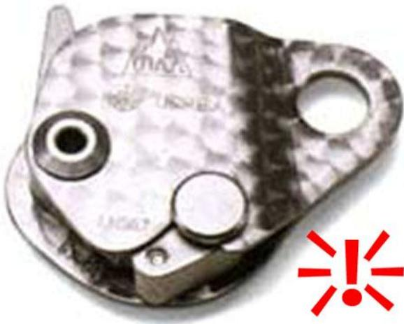
Рис. 47. Американский коромысловый зажим российского происхождения "Ushba Stop-Lock", сделанный из титана, не прошедший испытаний, так как перекусывал веревку при усилии 550 кг без всякого проскальзывания.
