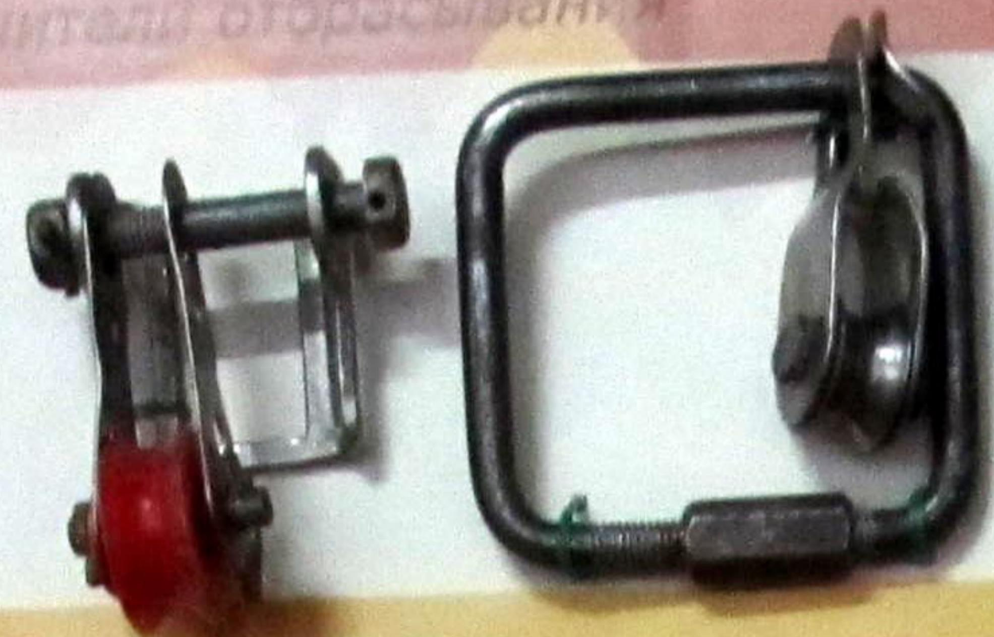
Использование веревок разного диаметра и разнокалиберных спусковых устройств (СУ) выявило интересные случаи поведения СУ. На тонких, мокрых и глиняных веревках рогатки еще как-то тормозили, если мотнуть веревку дополнительно через рог. Спелеолог с ШАЙБОЙ просто бесконтрольно «сквозил» до дна, а потом, слетев с веревки, слышал звон шайбы, улетавшей со скоростью пули в неизвестном направлении.
